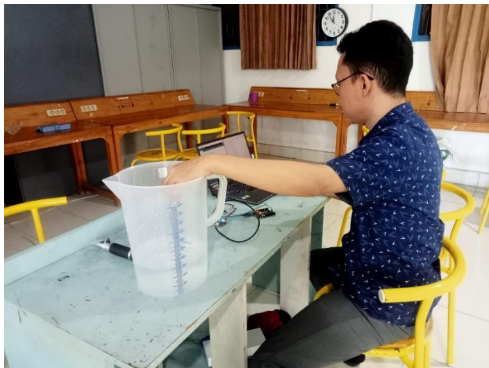
Gambar 5. Pengujian Salinitas Air dengan Sensor TDS
