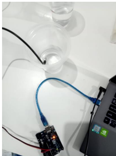
Gambar 8. Pengujian Suhu Air dengan Sensor Suhu
